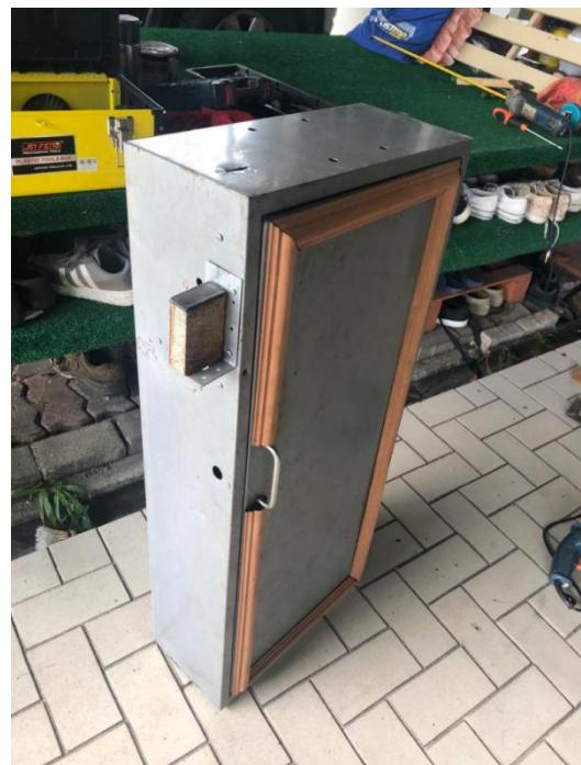
Akhir sekali, iaitu proses pemasangan litar pada model. Litar diletakkan pada casing yang disediakan. Terdapat beberapa lubang ditebus menggunakan driller untuk memudahkan kerja pendawaian dan proses penghasilan pintu selesai.
