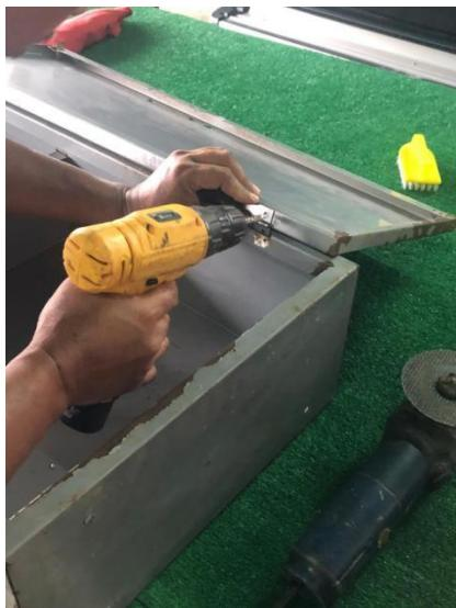
Seterunya, proses penambahbaikan pintu dimulakan. Antara penambahbaikan dilakukan adalah membuat peti atau casing untuk meletakkan litar. Casing ini dibuat supaya meletakkan litar supaya lebih teratur dan mudah apabila untuk melakukan kerja sekiranya terdapat kerosakkan pada litar.
