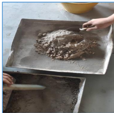
Rajah 6: Proses pengaulan simen, agregat (pasir), serbuk tayar getah dan air
