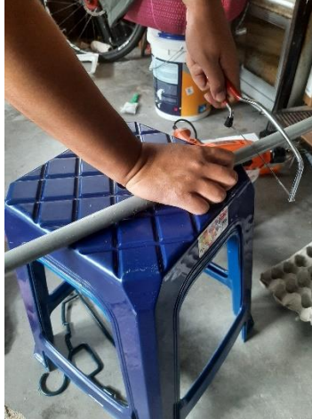
Rajah 3.5.9: Memotong Paip PVC
