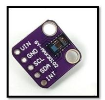
Figure 3.7<sup>©</sup> : OXIMETER SENSOR
