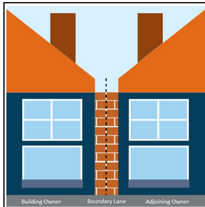
Rajah 10 : Dinding Pemisah
