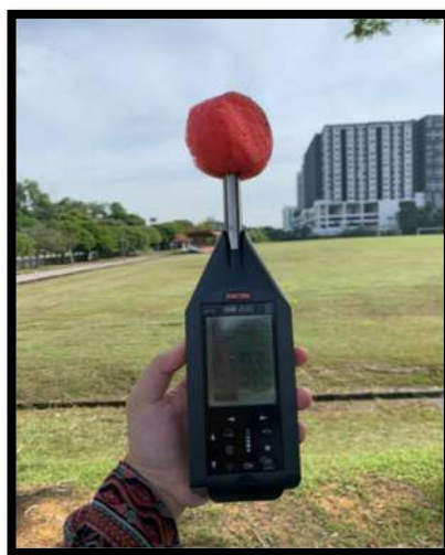
Rajah 4.2.1 Sound Level Meter untuk mengambil bacaan tahap hingar bunyi mesin pemotong rumput
