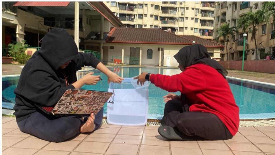
Rajah 5.4.5 Contoh dimana komponen elektrik itu diletakkan di atas bekas penyimpanan untuk mengambil uji kaji tahan kebocoran ketika saat beberapa
