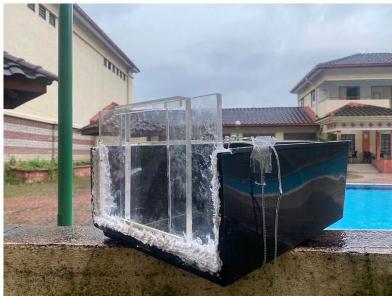
Rajah 5.4.3 Contoh pengedap silikon yang bewarna putih untuk memberi kekuatan bagi menyokong akrilik supaya kekal dan tidak berlakunya kebocoran
