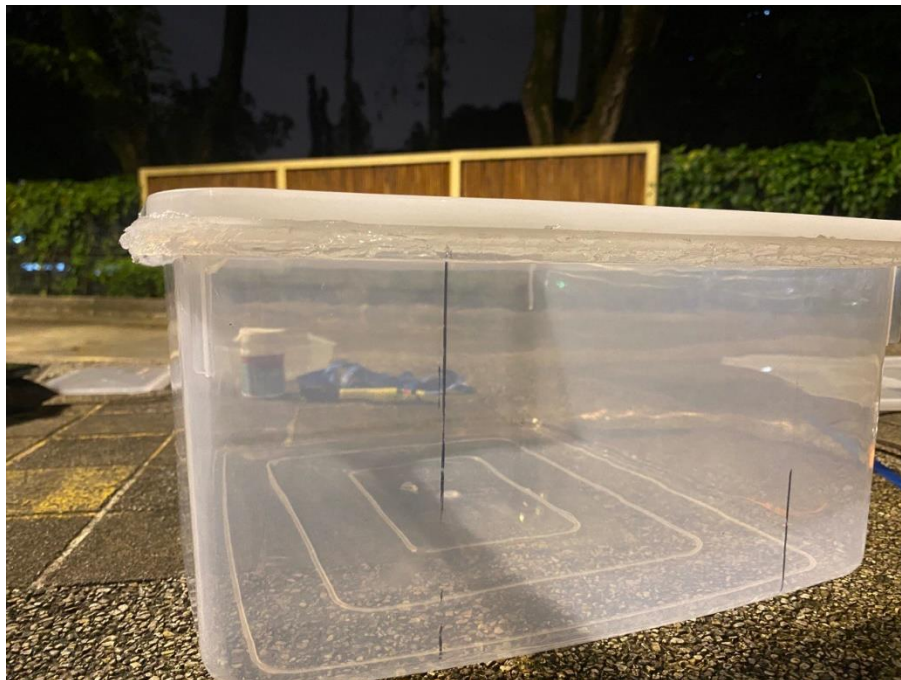
Rajah 5.4.1 Contoh pendedap silikon diletakkan disekeliling bekas penyimpanan
