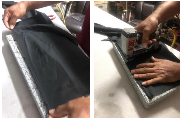
Rajah 3.5: Menampal kain untuk menutup panel.
