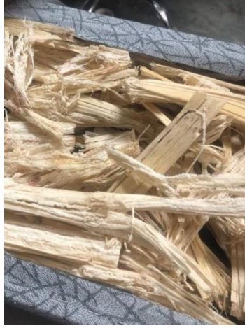
Rajah 3.4: Meletakkan hampas tebu ke dalam tiga panel.
