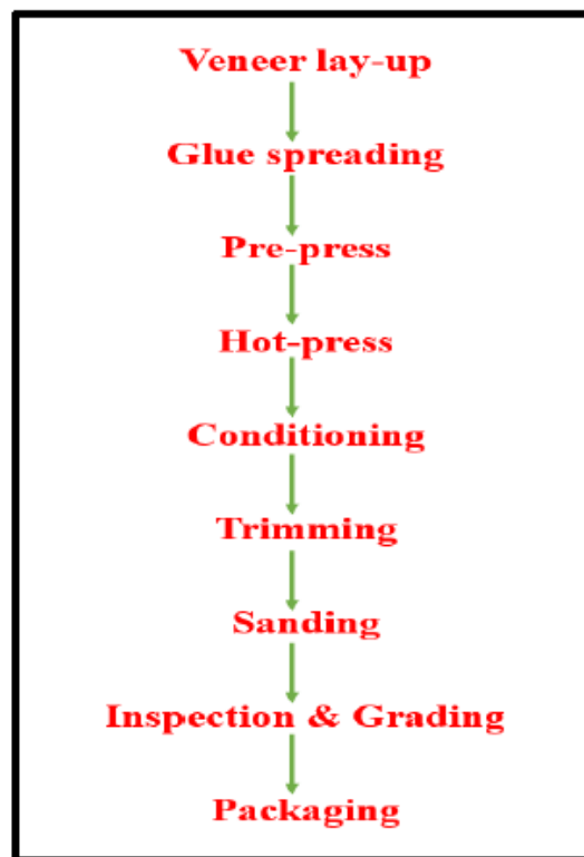
Diagram B2(b): Plywood Production Flow chart Rajah B2(b): Carta alir pengeluaran papan lapis
