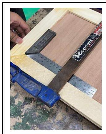
Rajah 65: Guna L Scape Untuk Mengukur Keselarian Produk
