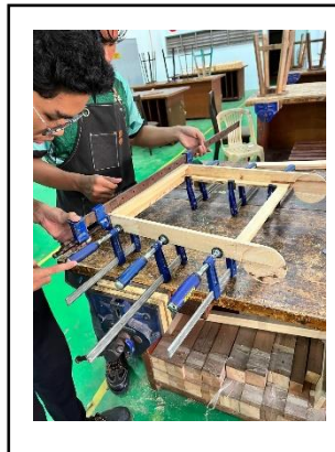
Rajah 81: Proses Gam, Clamp dan Nail Gun Stand
