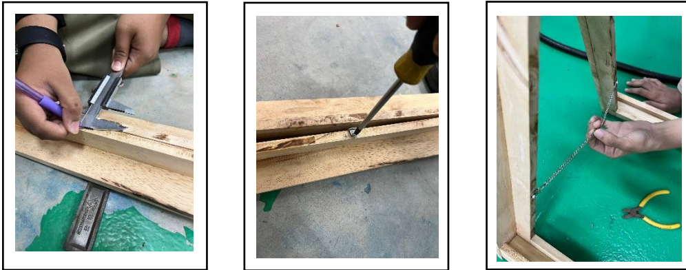
Rajah 82: Proses Tanda dan Memasang Rantai Pada Stand
