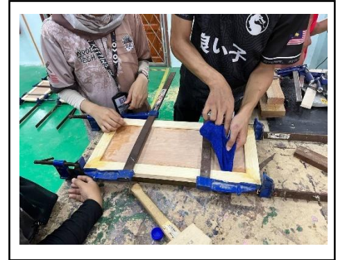
Rajah 64: Lap Gam Menggunakan Kain Basah
