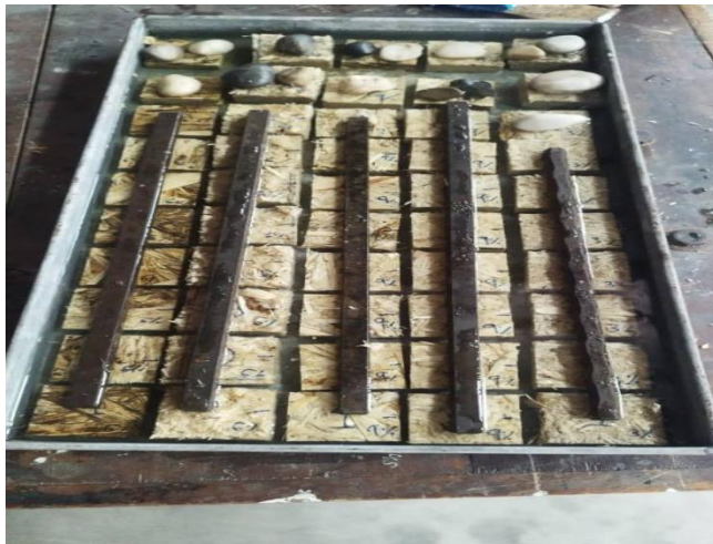
Rajah 3.15: Ujian Peratus Pembengkakan Ketebalan dan Peratus Penyerapan Air
