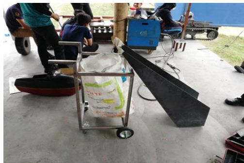
Rajah 3.6 Membuat penahan pada troli dengan kekunci
