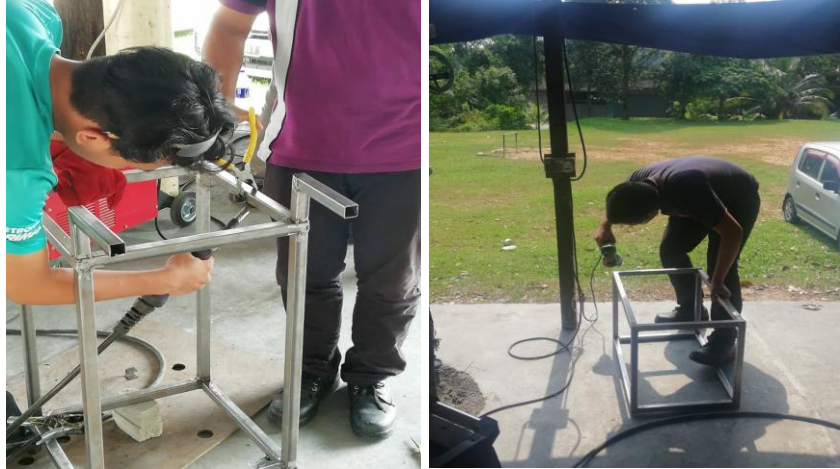
Rajah 3.5 Proses mencantum, mengimpal dan mencanai
