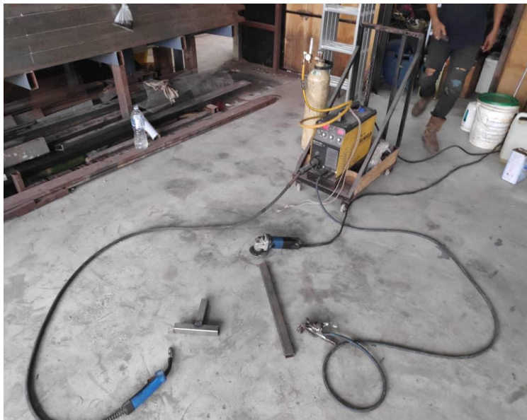
MIG welding set
