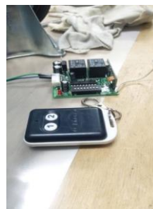
alat kawalan jauh yang disambungkan kepada komponen untuk mengerakkan tangga
