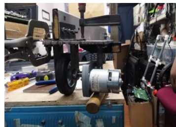
bahagian roda diikatkan di kaki sebelah yang mempunyai motor gear dc
