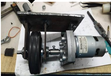
Motor dicantumkan pada roda untuk menggerakkan tangga
