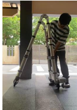
laraskan mengikut lantai bangunan seperti lantai tersebut dengan tinggi yang diinginkan
