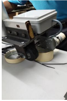
kotak menyimpan komponen diletakkan dan dilekatkan di atas roda yg mempunyai motor
