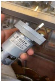
motor jenis gear dc 24v yang digunakan untuk gerakkan tangga tersebut
