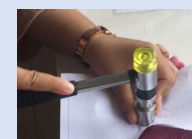
Acuan dipadatkan menggunakan tukul untuk dijadikan kapsul
