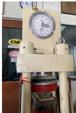
Rajah : Ujian Kekuatan Mampatan Yang Dilakukan Di Concrete Materials Laboratory Sdn. Bhd.
