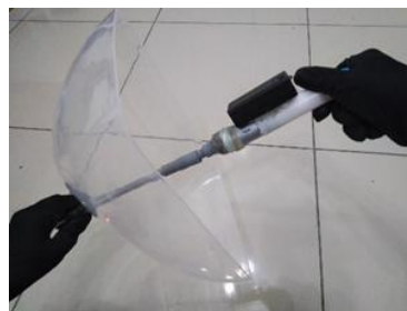
Motor dc dipasang pada hujung batang dengan cara memusingkannya
