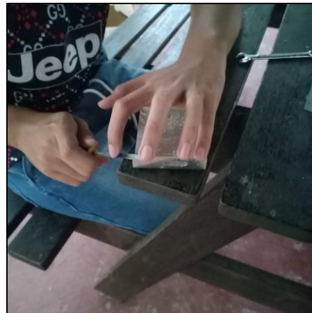
Rajah 3.6 viii : Proses Melicinkan Permukaan
