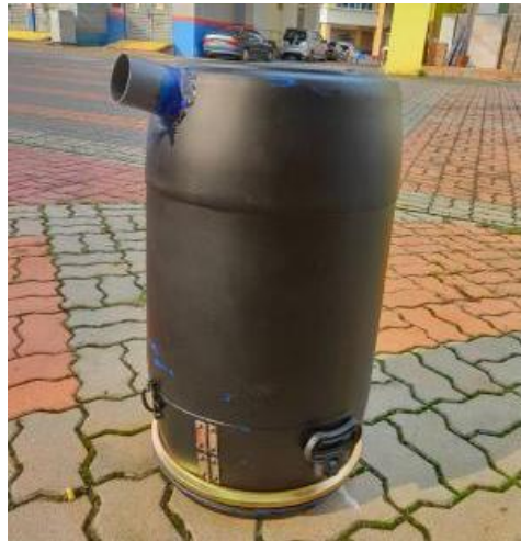
Rajah 3.6.3 Lubang pembuangan serta pintu yang siap di tebuk
