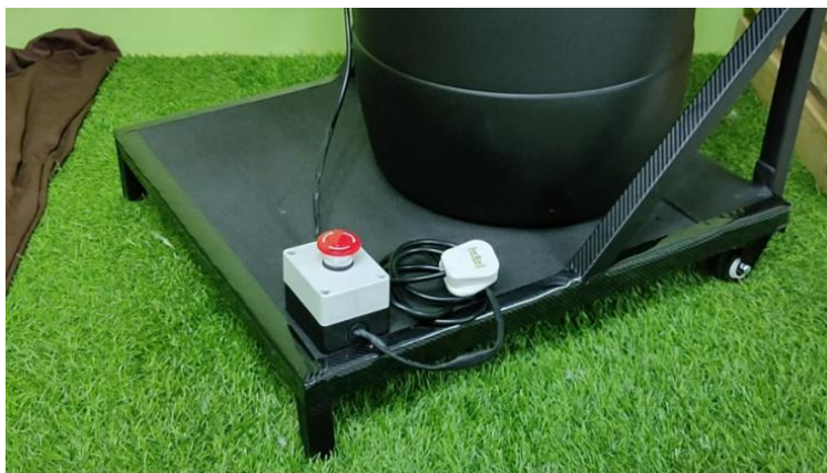
Rajah 3.6.11 Pemasangan foam anti licin dan stiker carbon yang telah dilakukan
