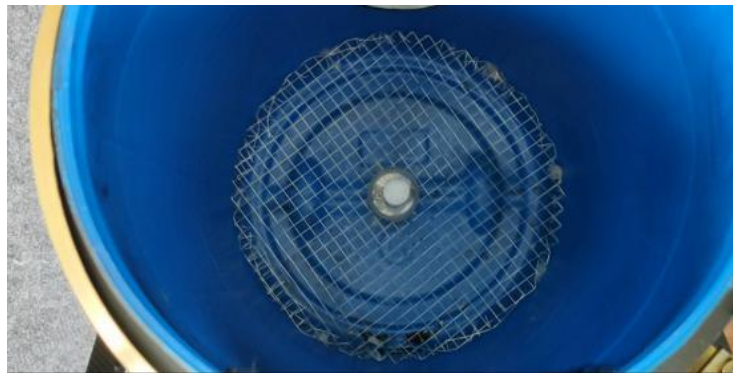
Rajah 3.6.8 Galvanized mesh dan Teflon dipasang di tapak tong menggunakan skru
