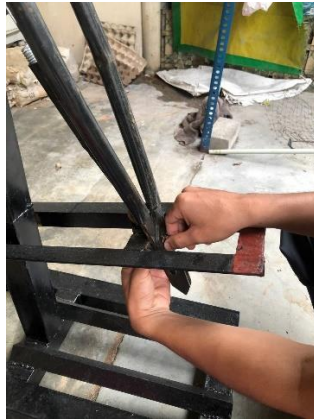
Pasangkan gunting kelapa pada lubang dan ketatkan dengan nat
