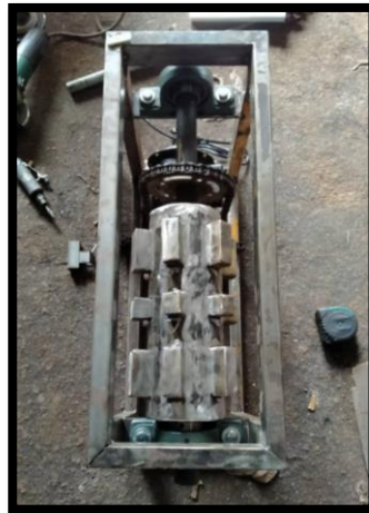
Rajah 3.5: Memasang pemampat
