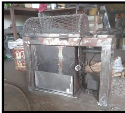
Rajah 3.7: Membuat penutup berbentuk melengkung di bahagian atas pemampat
