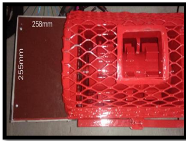
Rajah 4.0: Ukuran dan Saiz keseluruhan 'Smart Recycle Bin'.
