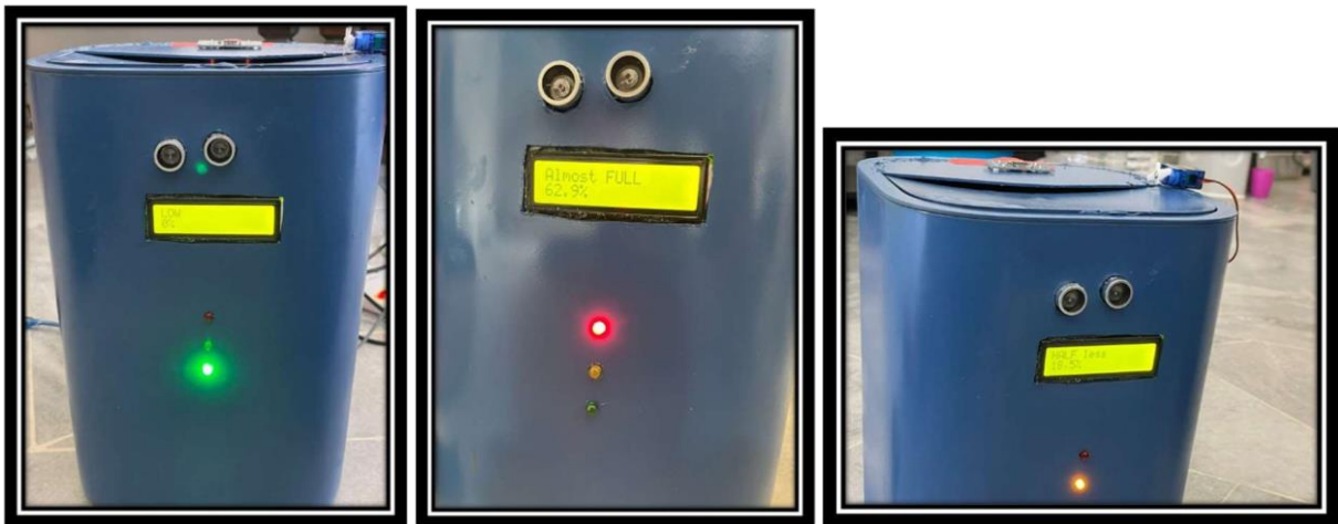
Jadual 4.2.5 menunjukkan perubahan lampu LED
