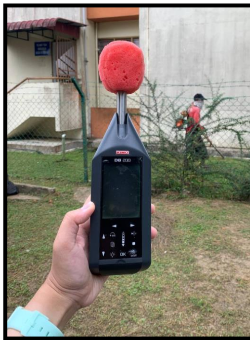
Rajah 4.2 "Sound Level Meter" untuk mengambil bacaan tahap hingar bunyi mesin rumput
