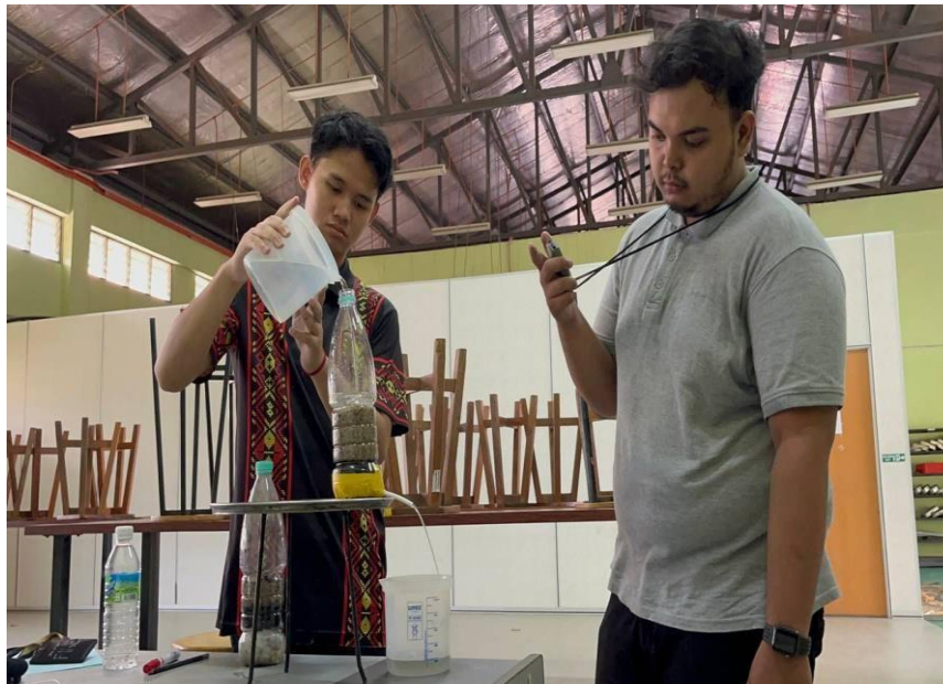
Rajah 3.9 Pengujian kebolehkerjaan bahan penapis
