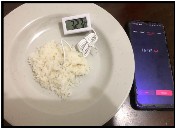
Rajah menunjukkan penurunan suhu nasi pada minit yang ke 15 iaitu 32.3
