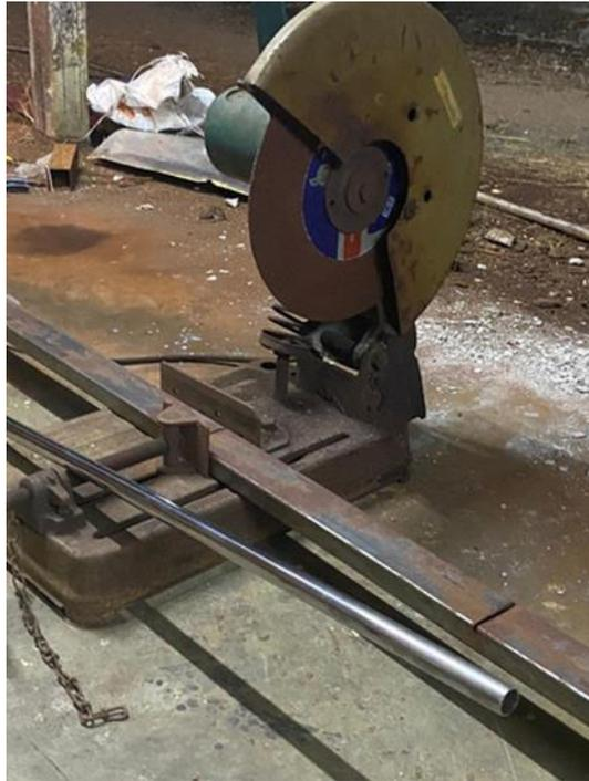
**Gambar Rajah 3.16:** Mesin pemotong besi
