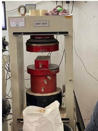
Rajah 3.4.1: Ujian kekuatan mampatan dilakukan di RTL Lab, Subang
