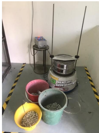
Rajah 3.4 : Sieve Analysis yang dilakukan untuk mendapatkan agregat bersaiz 10mm
