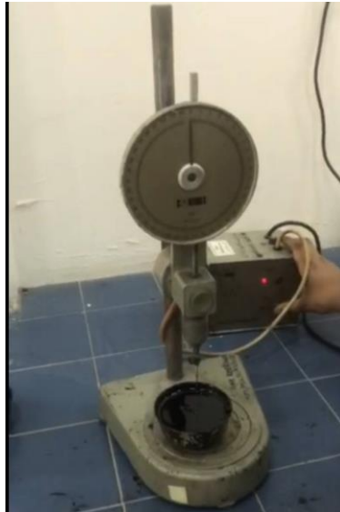
Rajah 3.2 : Ujian Penetration yang dijalankan di Makmal Jalanraya PSA
