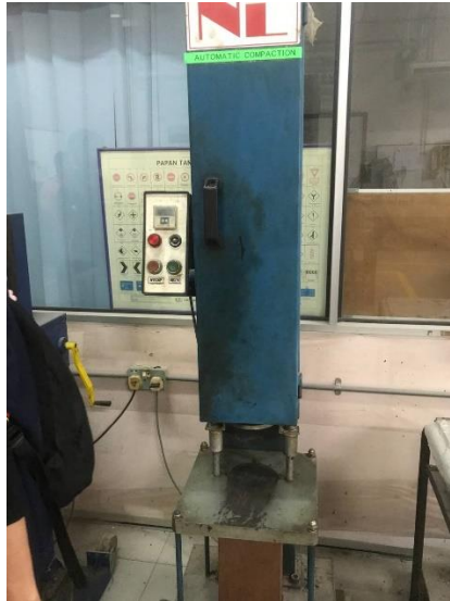
Rajah 3.5 : Ujian Marshall Stability yang dijalankan di UiTM Shah Alam
