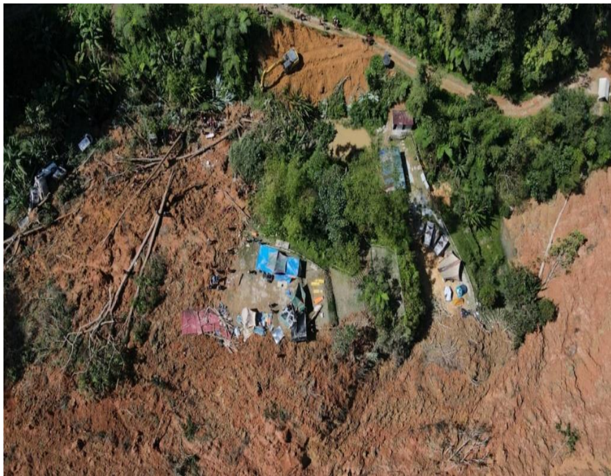
Rajah 2.5.3: Cerun Runtuh Kerana Kandungan Air Tinggi Dalam Tanah
