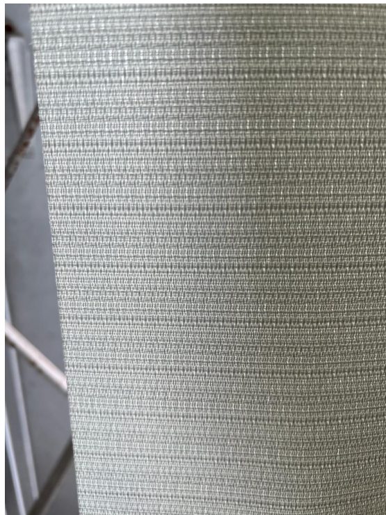
Rajah 21: Bahan yang digunakan untuk vertical louvre blinds adalah fabric louvre.
